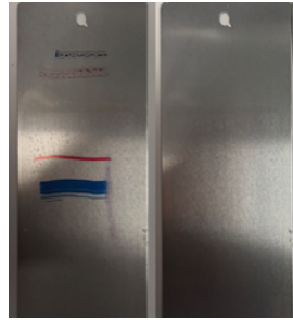
Abbildungen: Permanentmarker lassen sich leicht abwischen (links). Auch nach QUV-Belastung haben Tags und Graffiti keine Chance (rechts).
